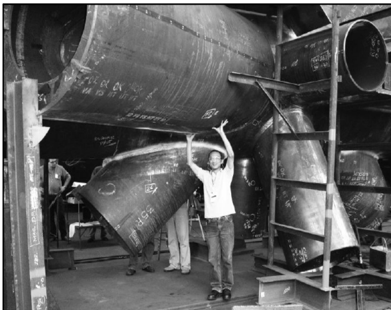
Figura 13 . Foto clássica do nó (junta tubular) de uma jaqueta de aço, ilustrando sua complexidade e magnitude (DEFILIPPO, 2007 e ALMEIDA, 2008).
